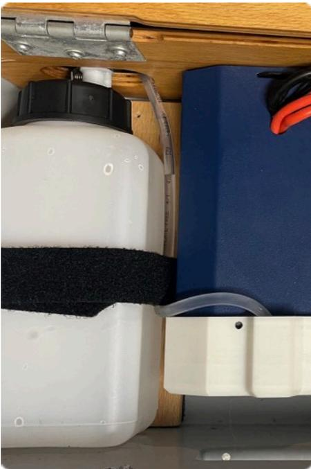
1. Klettverschluss öffnen, den Tank herausnehmen und vom Schlauch trennen
